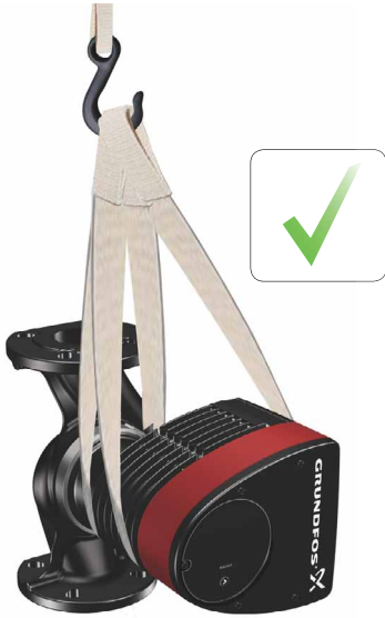
5. ábra A szivattyú helyes emelési módja
